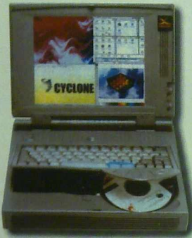
Блокнотный ПК Cyclone весом 3 кг имеет габариты 61x216x279 мм.
